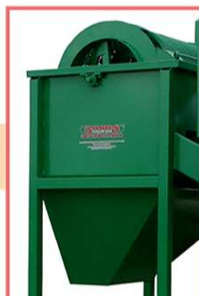
Paso en el tamiz giratorio con la expulsión de una gran parte del material desechable
