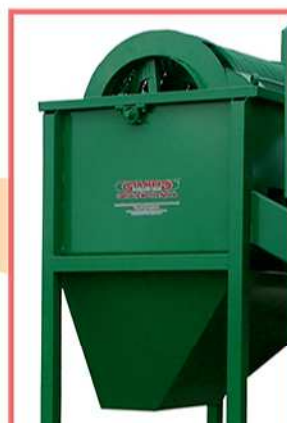
Passagem na peneira giratória com a expulsão de uma grande parte do material descartável
