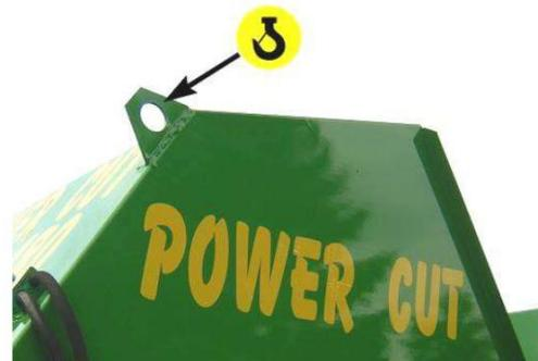
Antes de levantar a máquina, consulte a tabela de pesos no par. 3.2 para os vários modelos, para utilizar um elevador adequado.
