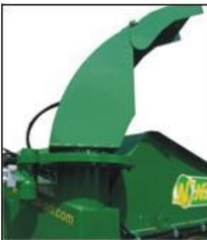
A torre giratória de 300° (equipamento opcional) com ajuste hidráulico permite descarregar facilmente o produto mesmo em áreas normalmente inacessíveis.
