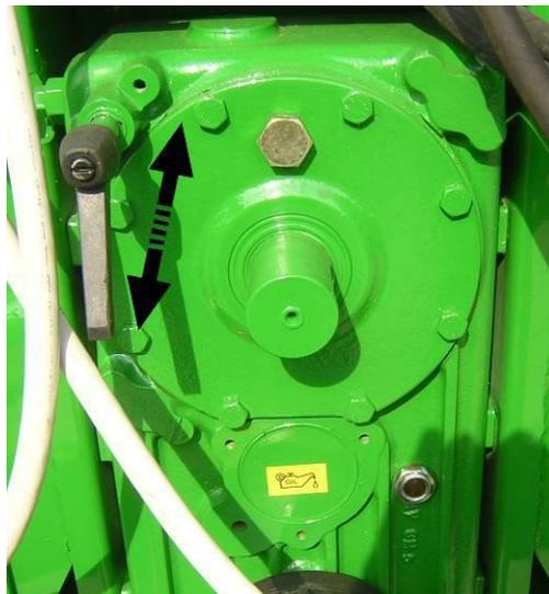
Caso seja necessário alterar a velocidade de rotação do ventilador durante a utilização da máquina, proceda da seguinte forma:
