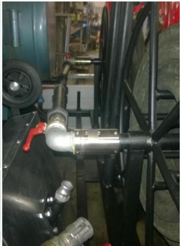
**Conectores rápidos para troca de bocais ou campânulas e conexão do tubo de vapor:**
