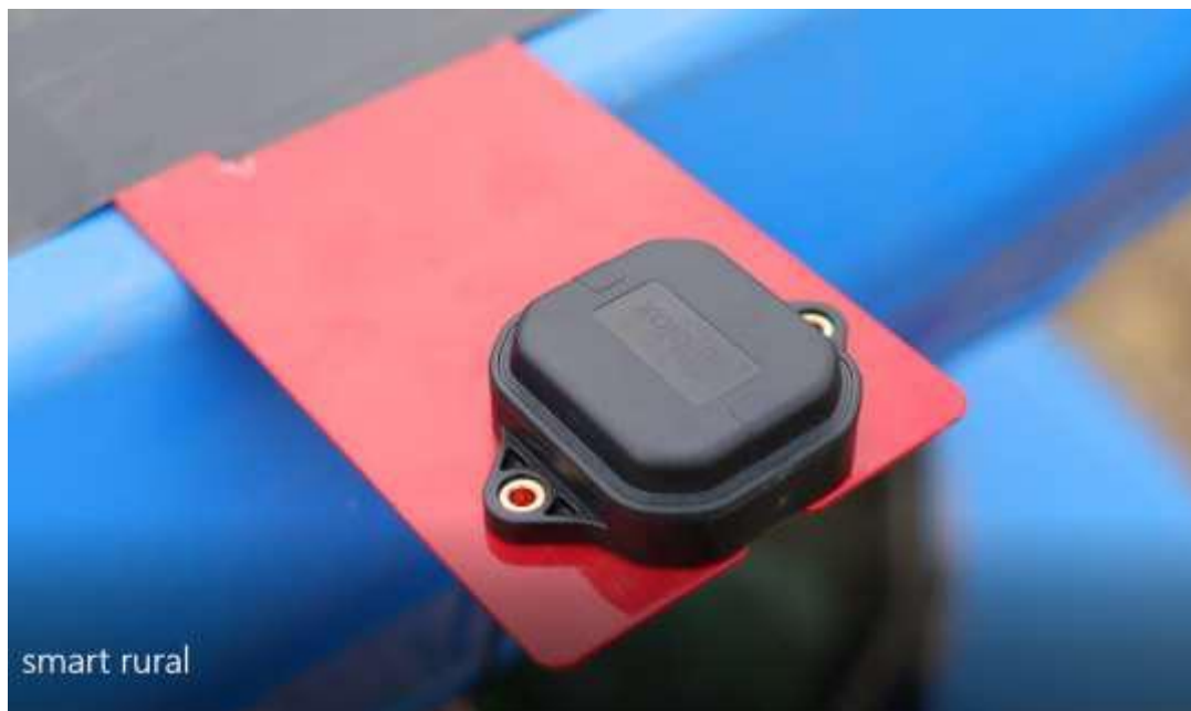
(Fig. 2-Antena RTK suportada pela placa metálica)
