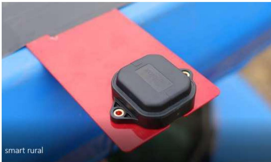
(Fig. 2-Antenne RTK supportée par une plaque métallique)
