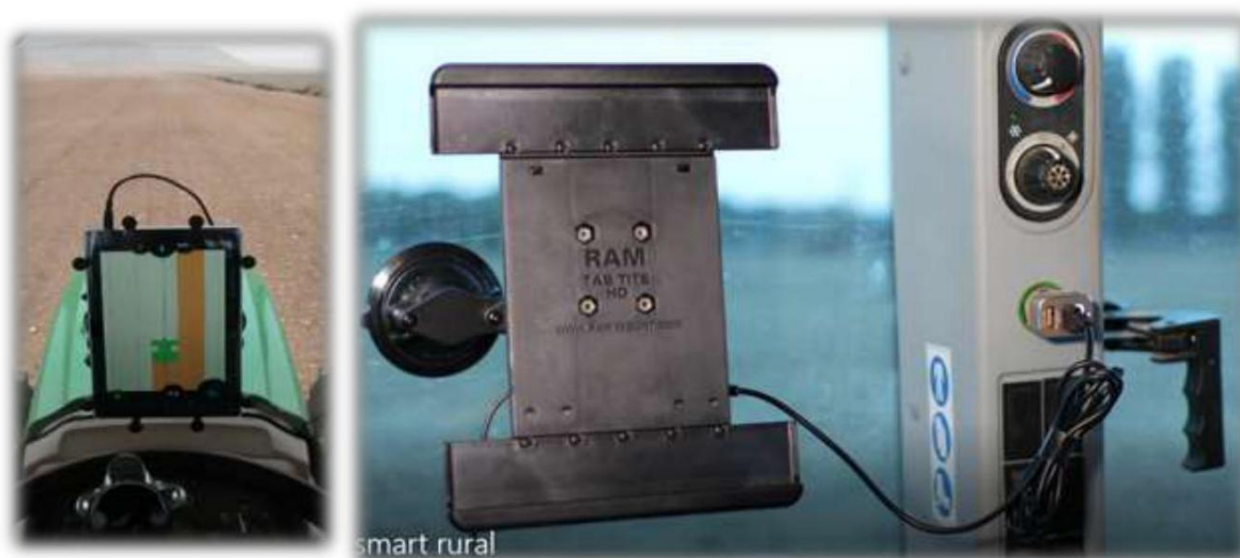
(Fig. 3-Conexión de la Tablet al encendedor del tractor con cable USB)
