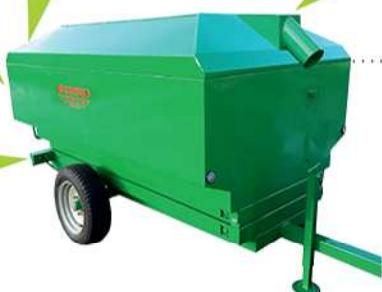
O reboque mod. PR / 15 é multi-usos: ele pode ser usado tanto como um recipiente, durante a colheita, tal como um reboque de transporte clássico através da remoção da tampa superior.
