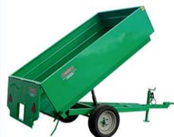
El remolque mod. PR / 15 es multiuso: se puede utilizar tanto como un recipiente durante la cosecha, como un remolque de transporte clásico a través de la eliminación de la tapa superior.
