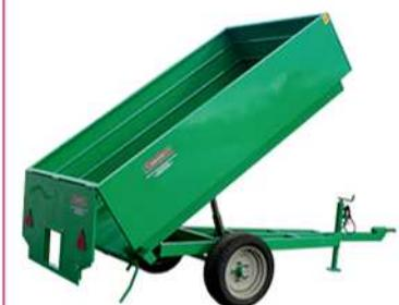
La remorque mod. PR / 15 est polyvalent: il peut être utilisé à la fois en tant que conteneur pour la collecte, comme une remorque de transport classique en retirant le capot supérieur.
