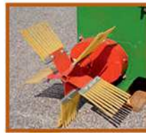
Escoba para la eliminación de la fruta de la corredera subyacente
