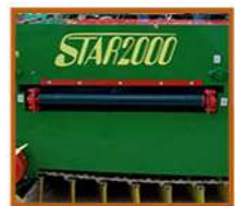
Cinta transportadora que recibe el fruto de escoba y los envía a los cilindros
