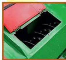
Tamizaje para la separación de impurezas a paratir de frutos por medio de rollos y tornillos sin fin de transferencia
