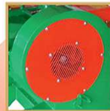
Aumento do ventilador com embreagem centrífuga interna
