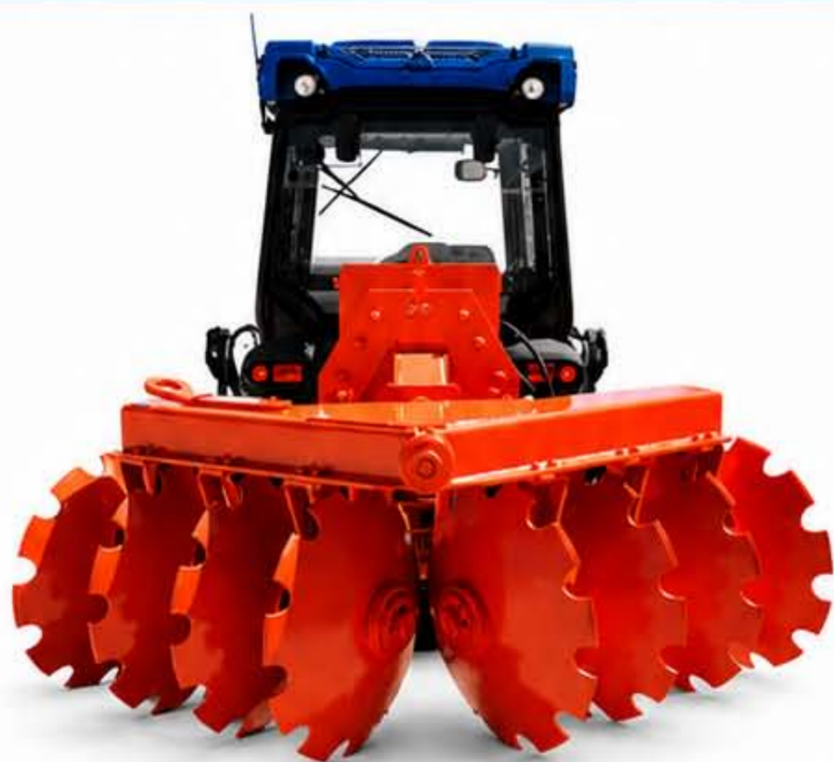
FI-GTVH/ER – Grade V avec attelage au Porte-Outils Arrière à attache rapide
