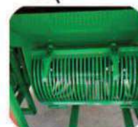
Grelha separadora + separador para pedras e terra
