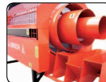
D. Calibreur concentrique Les caïeux saines et sélectionnées sont classées selon cinq calibres différents à travers quatre cribles cylindriques de 120 cm de long. Les caïeux à semer, de différentes tailles, sont ainsi triés de façon précise du plus gros au plus petit calibre.
