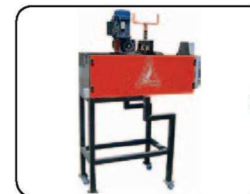
B. Égreneuse L'égreneuse, équipée de brosses et de bandes, sépare les caïeux sans les endommager et en évitant toute pression. La position des bandes se règle en fonction du calibre des têtes.
