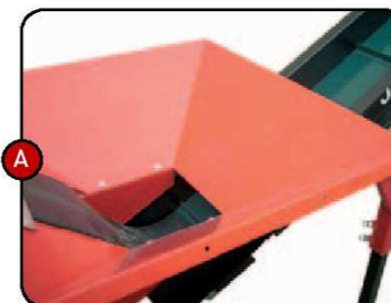
A. Tremonha de alimentação O comprimento da tremonha facilita a descarga das cabeças de alho que são elevadas até ao debulhador através de um tapete de velocidade regulável accionado por um motor eléctrico.
