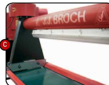
C. Tapis d'aspiration et finition Deux zones d'aspiration suppriment les peaux des têtes non exploitables. Tout au long de la bande mobile, les caïeux difformes et sans capacité de germination sont éliminés manuellement.
