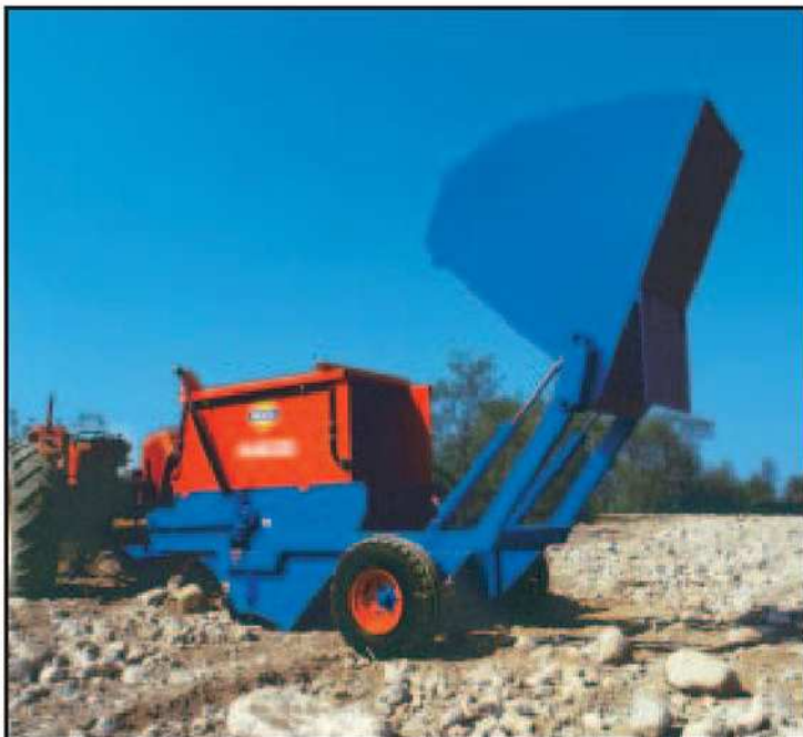
RST / 250-S também com rodas traseiras que podem ser movidas hidráulicamente para a remoção de pedras em vinhas e pomares.
