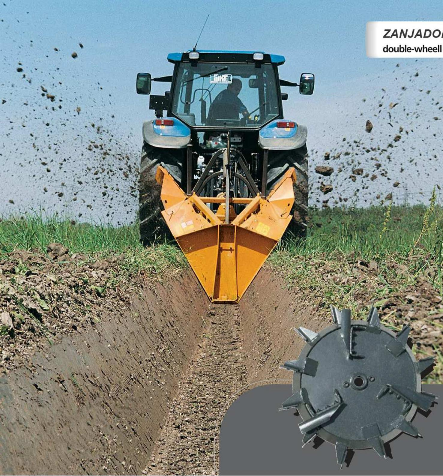
Los zanjadores rotativos de doble rueda están en lo más alto nivel en tecnología y desempeño para la creación y la Mantenimiento de zanjas de drenaje y riego.
