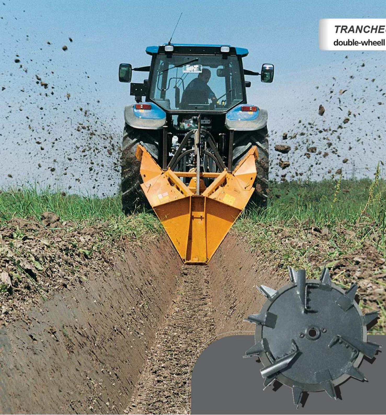
Les trancheuses rotatives à deux roues sont au plus haut niveau de technologie et de performance pour la création et la entretien des fossés de drainage et d'irrigation.
