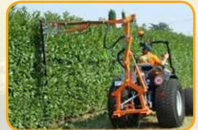
**IT** Bracci potasiepi con barra falciante da 150 e 200 cm per potatura di alberi e siepi Ø 3cm adatti anche a piccoli trattori. Sono dotati di telaio reversibile con 3 movimenti idraulici, distributore indipendente con cavi flessibili e di un sistema in grado di assicurare ogni angolo di taglio su entrambi i lati del trattore.
