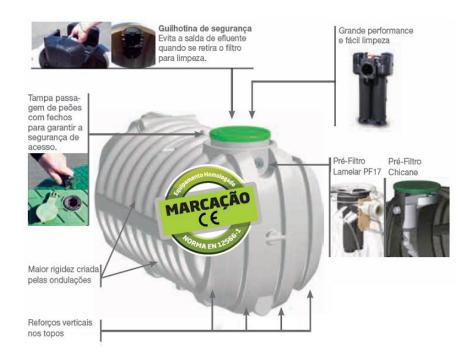
As Fossas Sépticas Milenium são um equipamento de tratamento de águas residuais domésticas, onde através de uma combinação de um processo decantação e de digestão anaeróbia, consegue-se atingir uma redução significativa da carga poluente.
