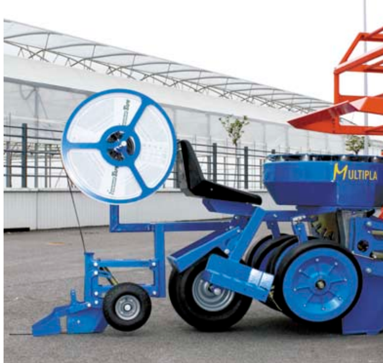
STENDIMANICHETTA CON VOMERE INTERRA MANICHETTA / WATER PIPE STRETCHING TOOL WITH PLOUGH SHARE TO EARTH WATER PIPE UP / SYSTEME POUR ETENDRE LE TUYAU DE L'EAU AVEC SOC POUR ENTERRE LE TUYAU DE L'EAU / EXTENSOR MANGUERA CON REJA ENTIERRA MANGUERA / SCHLAUCHLEGEGERÄT MIT SCHLAUCHUNTERPFLÜGSCHAR
