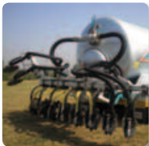
Apparecchiatura interralliquami ad azionamento idraulico, con dischi. Hydraulically-operated manure-burying equipment with discs.
