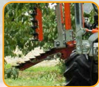
Barra inferiore con molla antiurto Lower cutting bar with spring safety Barre inférieure avec ressort antishock Unterschnittmesser mit Stoßsicherungseinzug Barra inferior con muelle anti-golpe
