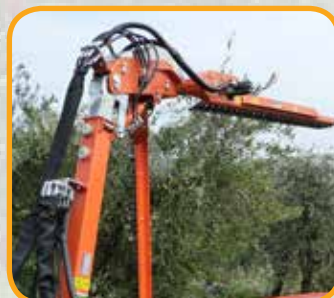
Top superiore con snodo 180° Top cutting bar with 180° tilting Top supérieur avec articulation 180° Oberbalken mit 180° Gelenk Tope superior con articulación 180°
