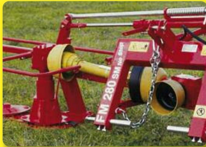
**IL SISTEMA NO STOP, SI BASA SULL'AZIONAMENTO DALL'ALTO DEL PRIMO DISCO, MIGLIORANDO IL DEFLUSSO DEL FORAGGIO, E CONSENTENDO ALL'OPERATORE DI NON AVERE FERMATE PER INGOLFAMENTO**
