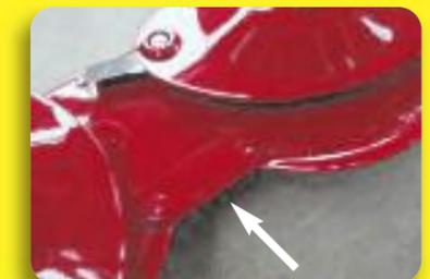
*En el caso de fuerte choque y doblego de las cuchillas, la placa impide el perjuicio de la caja de los engranajes.
