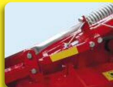
**DISPOSITIVO DI BLOCCAGGIO AUTOMATICO PER IL TRASPORTO SU STRADA E DISINNESTO TRAMITE FUNE.**
