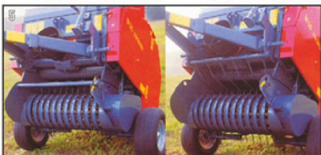
**4.** La cámara de compresión a rodillos es fija. El extensor (de serie) permite descargar la paca más allá del radio de cierre de la puerta.
