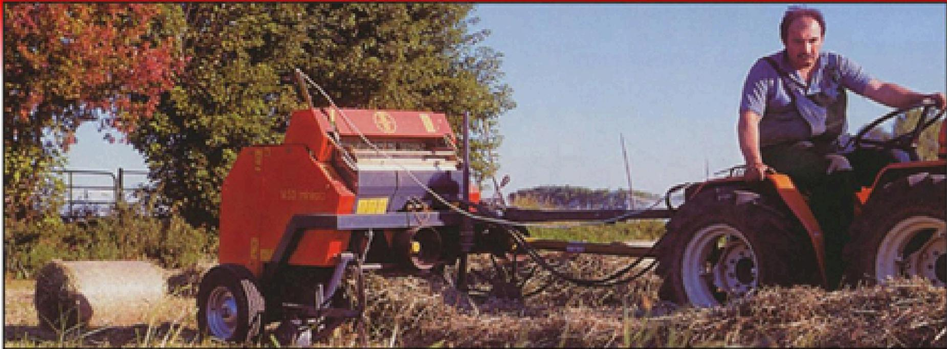
**1.** La M50 MINIROTO est une presse à balles rondes à rouleaux avec presse fixe. L'encombrement et les poids minimaux en font une machine particulièrement adaptée pour l'emploi dans les zones de montagne et pour l'élevage de chevaux.
