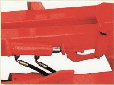
Dispositivo per il blocco idraulico della piattaforma. Système de blocage hydraulique de la plate forme. Dispositivo de Bloqueo hidráulico de la plata forma. Hydraulischblockierung der Rampe. Hydraulic blocking of the platform.
