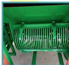
Grade separador + pequeno portador terra e pedras
