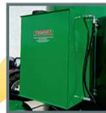
Tanque de combustível
