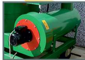
Generador de calor
