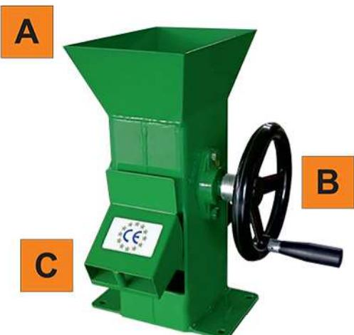
Machine pour l'alimentation manuelle avec un milieu de capacité variable. La machine convient pour séparer les graines de noisette de sa coquille. Idéal pour la production domestique ou à faible énergie.
