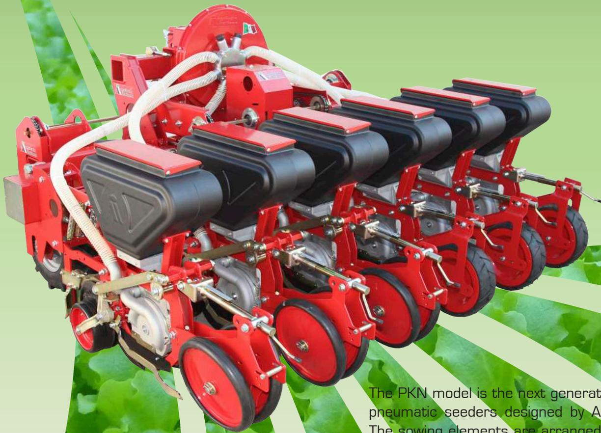
Il modello PKN rappresenta la nuova generazione di seminatrici pneumatiche di precisione concepite da Agricola italiana. Gli elementi di semina sono disposti direttamente sul telaio principale, in modo da rendere la seminatrice più compatta e stabile, caratteristica principale richiesta per queste tipologie di semina.
