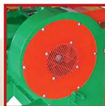
Aumento do ventilador com embreagem centrífuga interna
