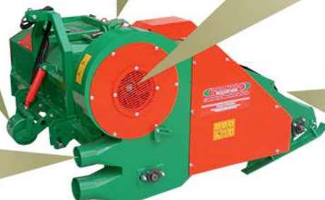
Caja con limitador de potencia en presencia de cuerpos extraños
