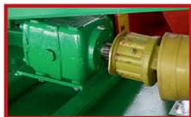
Boîte avec limiteur de puissance en présence de corps étrangers
