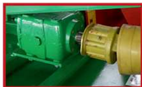
Caja con limitador de potencia en presencia de cuerpos extraños
