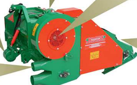
Caixa com limitador de potência na presença de corpos estranhos
