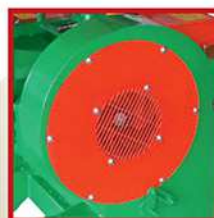
Fan accrue avec embrayage centrifuge interne
